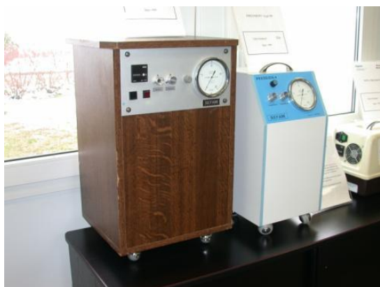
Рис. 1. Слева первый серийный СИПАП-аппарат компании SEFAM (Франция) массой 23 кг.
